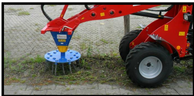
Obrázok 13- Metóda rotačných kief použitá v intraviláne Obrázok 14- Rotačné kiefy použité na poľnohospodárskej pôde
