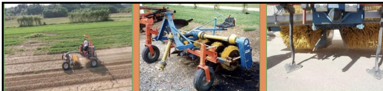
Obrázok 32- Zariadenie používané pri mechanickej kontrole burín v poľnohospodárstve
