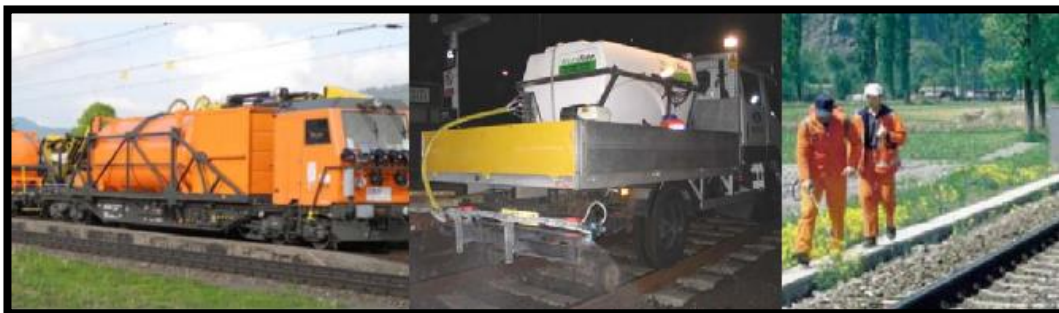
Obrázok 42- Rôzne metódy aplikácie pesticídov na železničných tratiach
