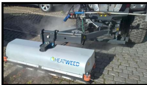
Obrázok 44- Prístroj, ktorý využíva horúcu vodu na zneškodňovanie burín
